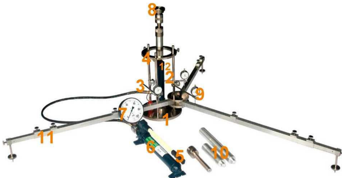
Rys. 1.2 Aparatura VSS z jednopunktowym pomiarem przemieszczenia płyty
