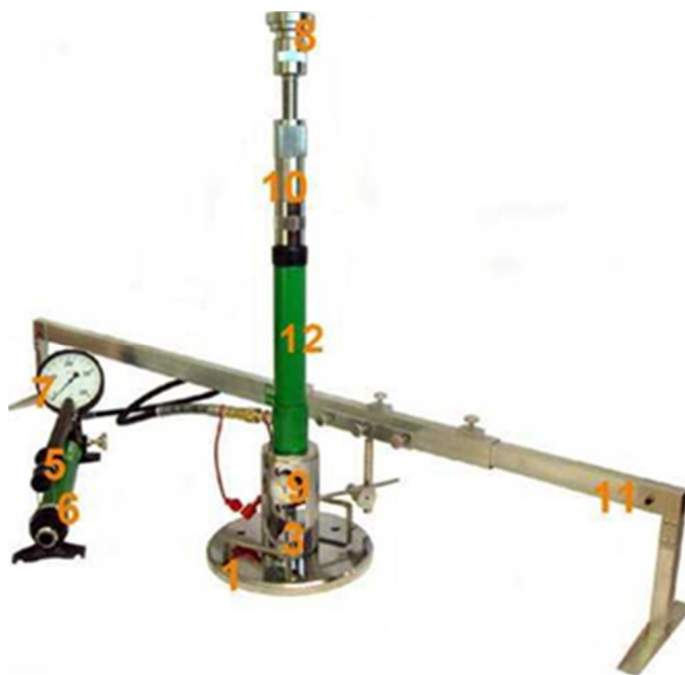
Rys. 1.2 Aparatura VSS z jednopunktowym pomiarem przemieszczenia płyty
